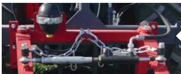
Système hydraulique avec azote stable Vérin
